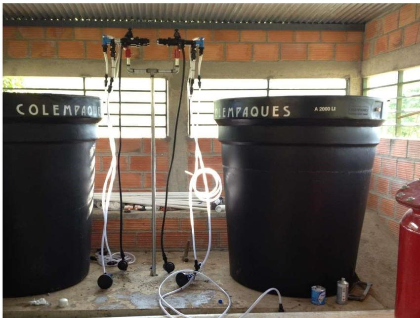
Fig 4. Inyectores de fertilizantes hidráulicos y tanques de 2000 litros
