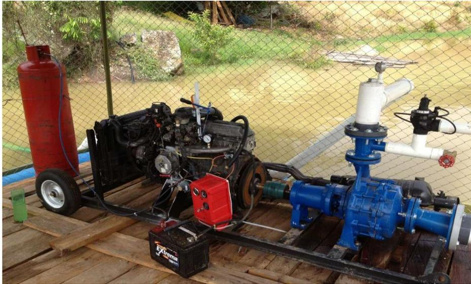
Fig 1. Balsa de bombeo con bomba de dos etapas con motor a gas
